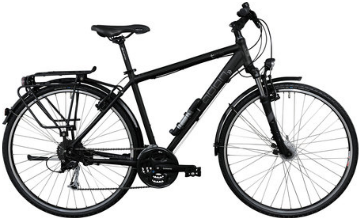
Trekkingrad Radon – Sportrad mit Gepäckträger/Schutzbleche / Licht Shimano Schaltung / Federgabel: Suntour NEX 80mm
