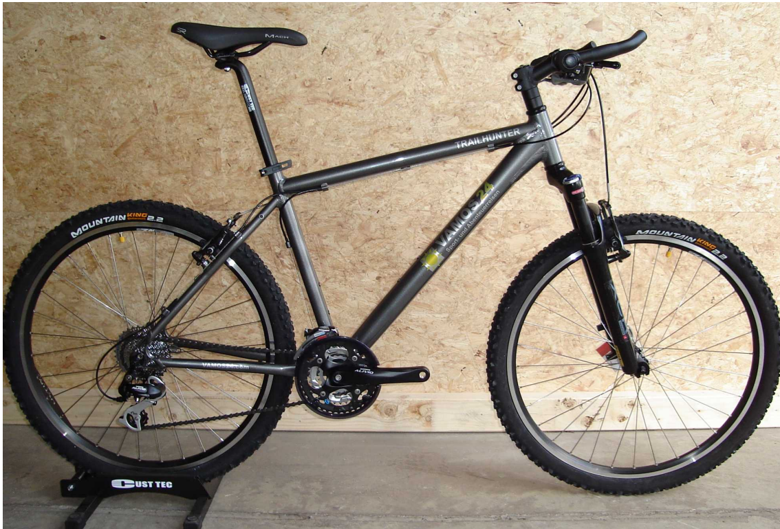
MTB Hardtail Shimano (26" Laufrad), Shimano Schaltung Federgabel: SR Suntour 100mm
